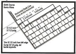
Fig. 5G Shingle Application Instalación de tejas
