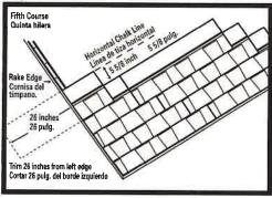
Fig. 5F Shingle Application Instalación de tejas
