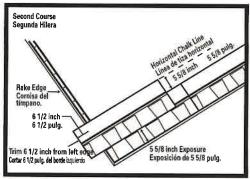
Fig. 5C Shingle Application Instalación de tejas
