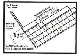
Fig. 5E Shingle Application Instalación de tejas
